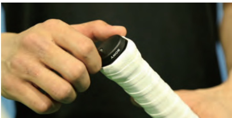
ボール速度、回転数、スイング速度を測定。改善の前後の差が明確に。
